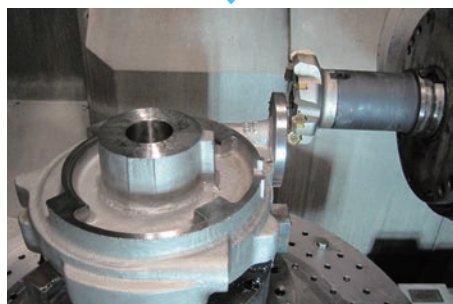
(ケーシング加工中)
